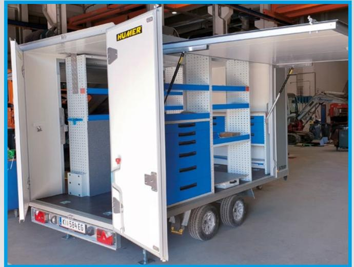
Taller móvil instalado dentro de un remolque en aluminio o resina de vidrio.
